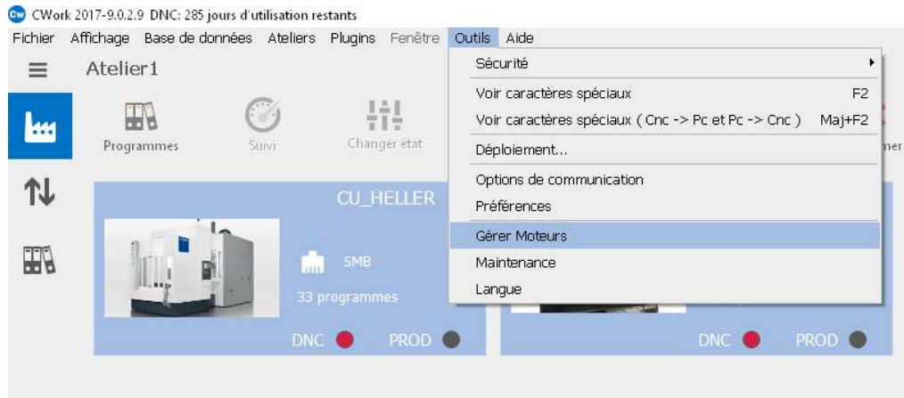
Illustration 6: Accès à la gestion des moteurs
