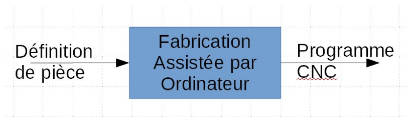
Illustration 4: Exemple de système (F.A.O) analysé fonctionnellement
