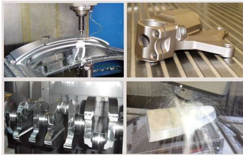
Illustration 2: Exemples d'usinages 5 axes continus
